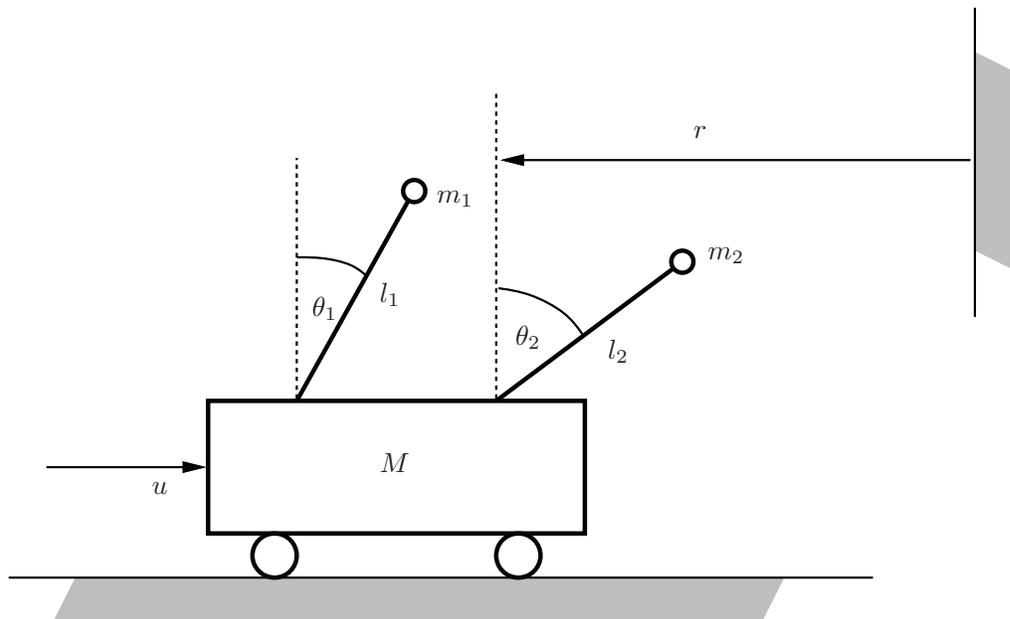
Abbildung 1: Kontrolle eines Wagens mit zwei Pendeln.
